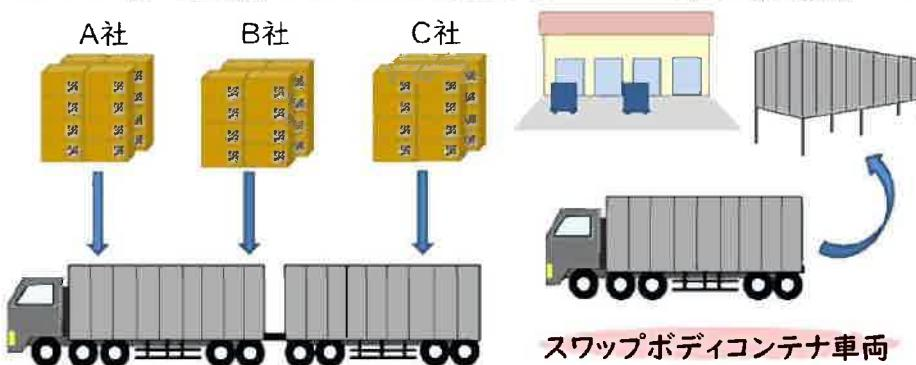
ダブル連結トラックに配送先が同じ複数の荷主企業の荷物を積み込むことで輸送効率アップ
